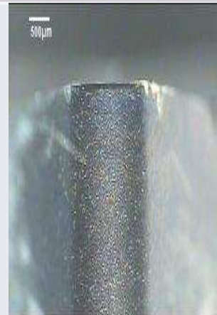
Usure pièce avec revêtement Nanocouches
