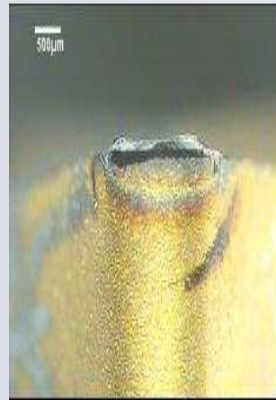
Usure pièce avec revêtement du commerce
