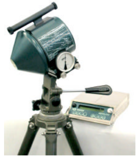
Dispositif de mesure de l'inclinaison
